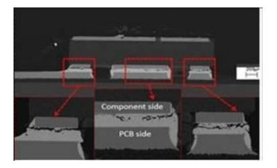
高空洞比会导致 LED 焊点在冷热冲击温度循环测试后产生裂纹 , 引起灯具疲劳失效。
